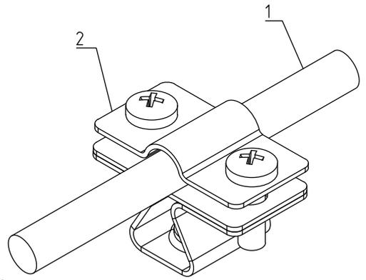
Пример крепления держателя на поверхность из сэндвич-панели (для кровли или фасада):
