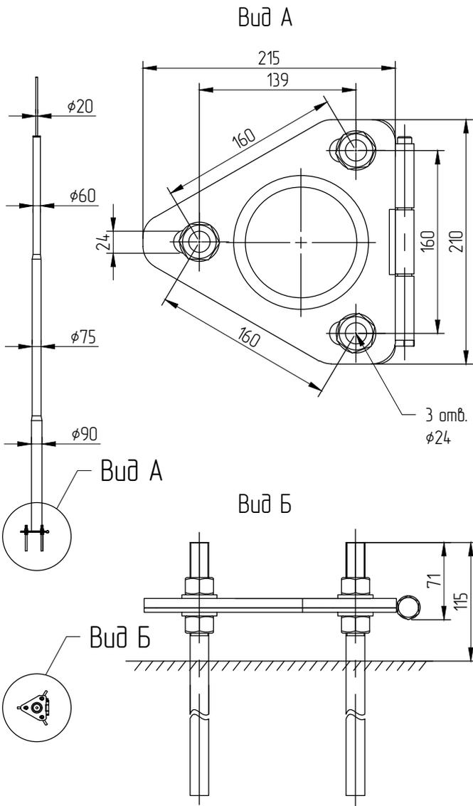
Схема основания молниеотводов от 15 до 25 м
